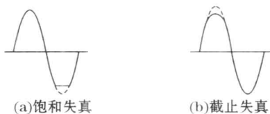
图 1-5 静态工作点对 u_o 波形失真的影响
