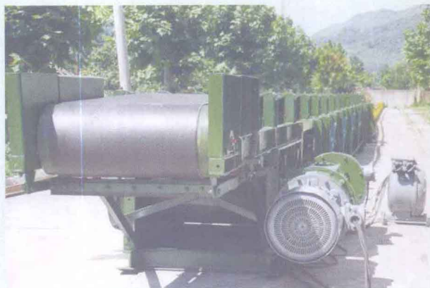
六枝工矿集团宏狮机械制造有限公司生产的DTL钢架落地式带式输送机
