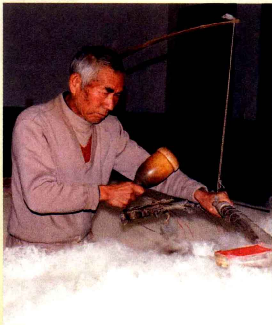
◆ 铁钩钩在弹弓上左手握弹弓，右手执弹槌弹弓弦
