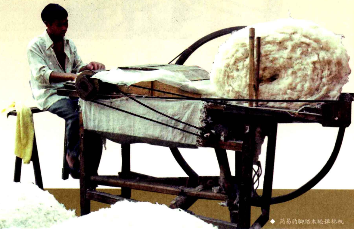
◆ 柜式脚踏弹棉机弹棉花
