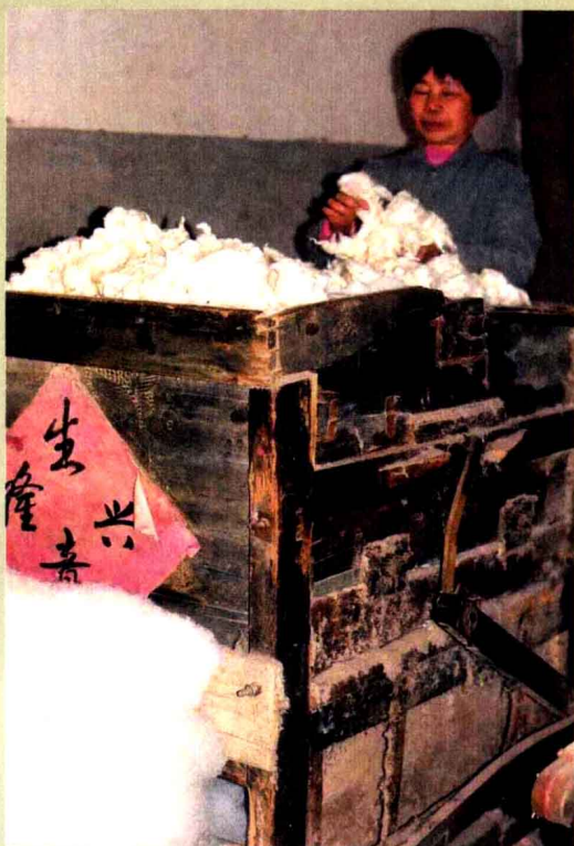
◆ 柜式脚踏弹棉机弹棉花
