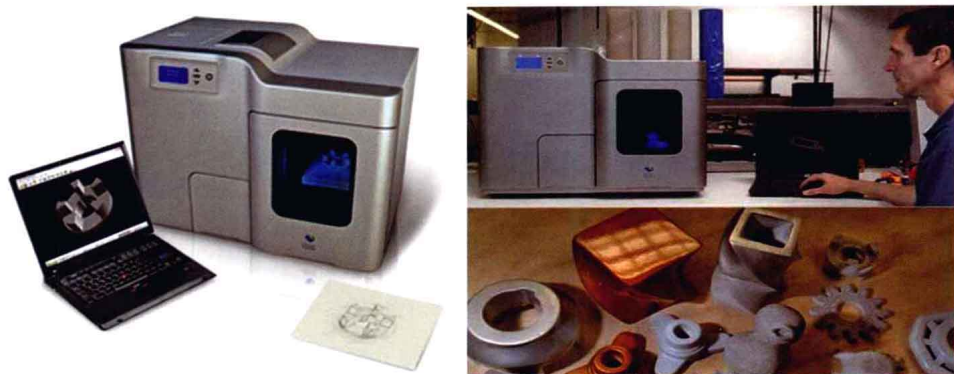
图 1—13 图中是 Desktop Factory 公司生产的 125CI 三维打印机。三维立体打印属于一种快速成型 (rapid prototyping) 技术，是一种由计算机辅助设计 (CAD) 数据通过成型设备以材料累加的方式制成实物模型的技术。这一成型过程不再需要传统的刀具、夹具和机床就可以打造出任意形状。它可以自动、快速、直接和精确地将计算机中的设计转化为模型，甚至直接制造零件或模具，从而有效缩短产品研发周期、提高产品质量并缩减生产成本。图片摘选自 http://www.nytimes.com 。
