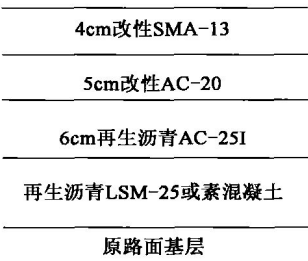
图 1-12 广佛高速公路路面大修典型结构示意图
