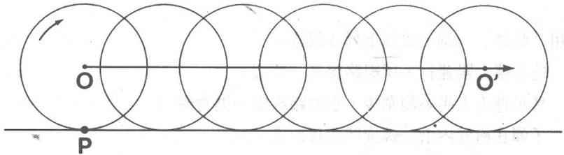
( 車輪在平地滾動，它軸心的軌跡是一水平線，車輪邊一定點的軌跡是一曲線——旋輪線。 )
