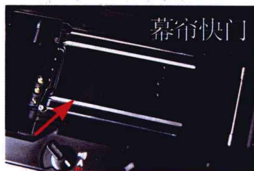
■ 图1-28 135单反相机的幕帘快门
