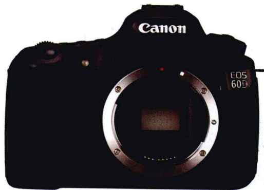
■ 图1-9 135 APS画幅数码单反相机
