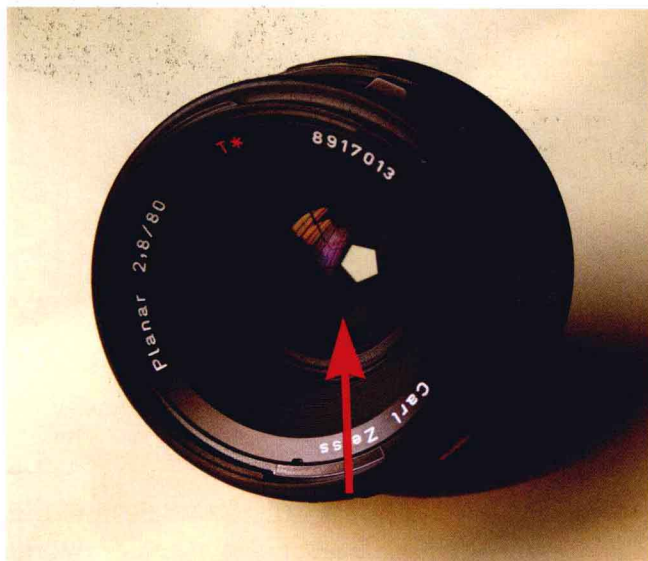
■ 图1-26 镜头里面收起的光圈
