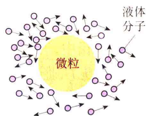
图7.2-6 微粒很小时,分子沿各方向对它的撞击不平衡。
