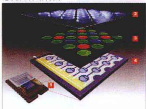
1 低通滤镜 2 微型镜头 3 RGB滤镜 4 感光元素点
