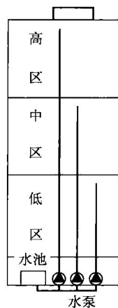
图 1-4 无水箱并联给水方式
