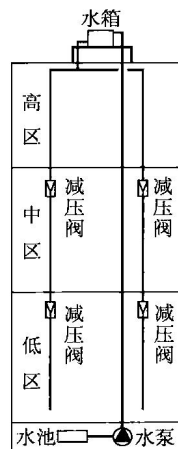
图 1-7 垂直立管循序减压给水方式
