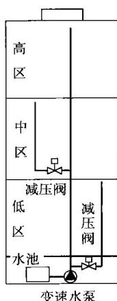
图 1-8 无水箱减压给水方式
