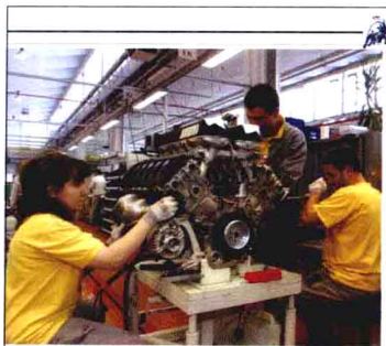
V型发动机具有两排气缸，两个气缸组，因此可以由两人或三人同时组装一条发动机
