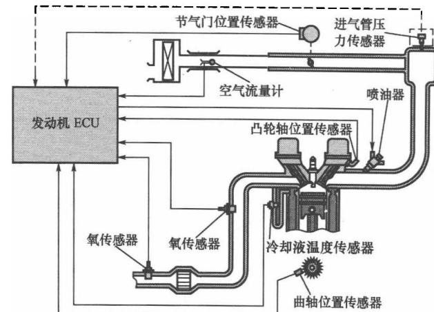
电控燃油喷射系统组成示意图
