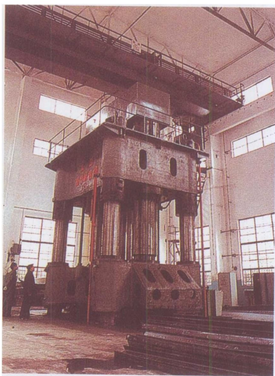
▲ 南海机械厂液压机（3150吨）安装
