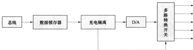
图 1-11 模拟量输出接口内部电路框图
