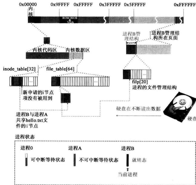
这张图描绘了操作系统运行时的一个场景，最上面的一个横条表示的是内存，其上的 0x00000、0x9FFF 等都是内存地址值。在内存示意图上，用颜色和灰阶表示了操作系统的内核、缓冲区、虚拟盘区和主内存区。从内存示意图中通过虚线向下引出了更多的横条，它们是在对内存中的局部区域进行放大。这些局部区域就是这个场景中需要关注的内存的细节，它们表现了涉及的代码和数据在内存中的精确位置。虚线箭头表示数据的传递和挂接情况。我们在图中绘制了硬盘的状态，表示此时硬盘正在不断地读出数据。另外，在图的最下方，用三个小竖条表示了三个进程的状态，灰色表示等待状态，黑色表示就绪态，小竖条中的空白表示进程已用的时间片。
