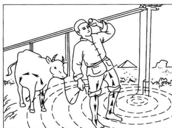
图 1.2.3 跨步电压触电
