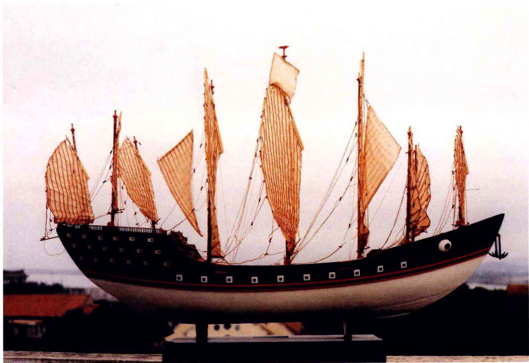
图22(下) 护卫兵船复原模型 明 据1958年山东梁山宋金河故道出土原件制作。原件长21.8米,腰宽3.44米,最大舱深1.4米,分为十三舱。模型长111厘米,宽18.2厘米,高8厘米。
