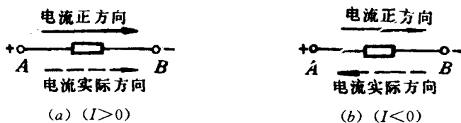
图 1—4 电流的正方向和实际方向
