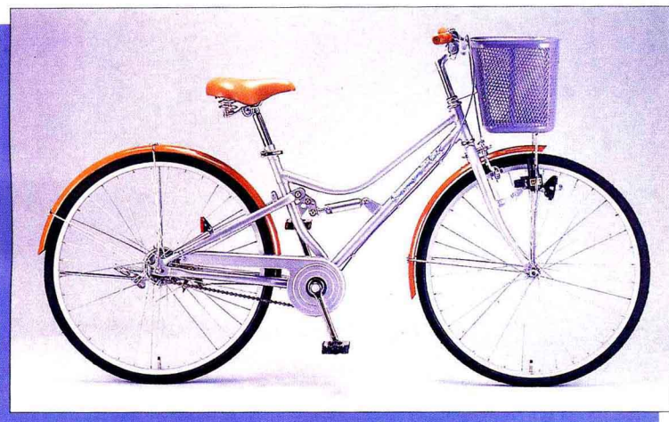
采用新型避震车架的自行车
