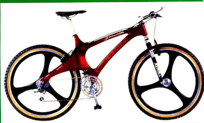
碳纤维整体车架和车轮的变速自行车
