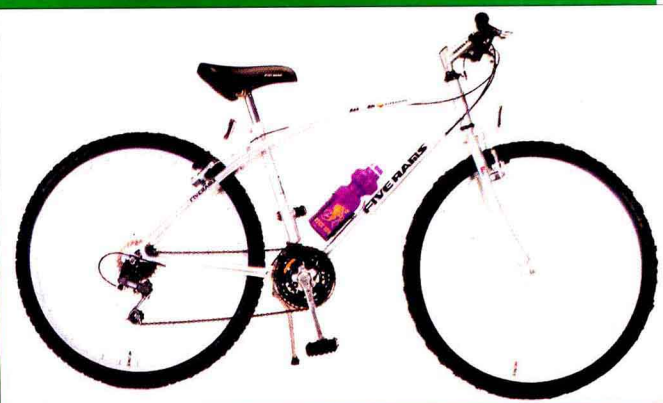
双曲线形车架变速自行车
