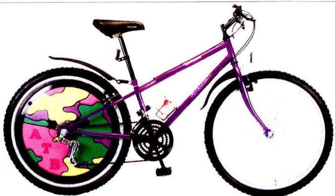
采用辐板型后轮的变速自行车
