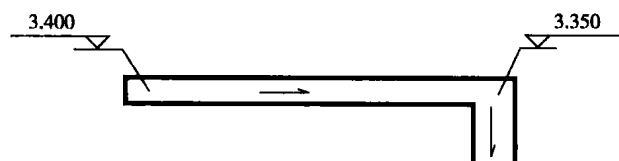
图 1-2 平面图中沟渠标高标注法
