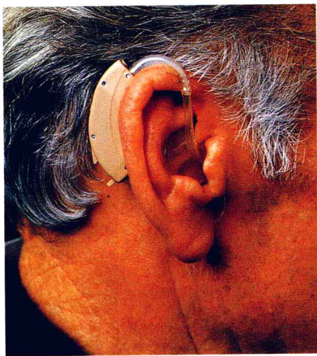
↑ 在这个轻便的助听器中，传声器和扩音器都安装在耳朵后面被托住的部件里。一根金属丝通到一个极小的耳内扬声器上。
