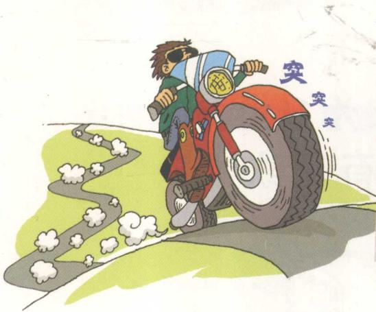
将轮胎上的花纹设计为纵向（与前进方向平行），不仅可以在车轮转动时降低车体摇晃的程度，还可以防止轮胎向两侧打滑。摩托车的前轮就是这样设计的。
