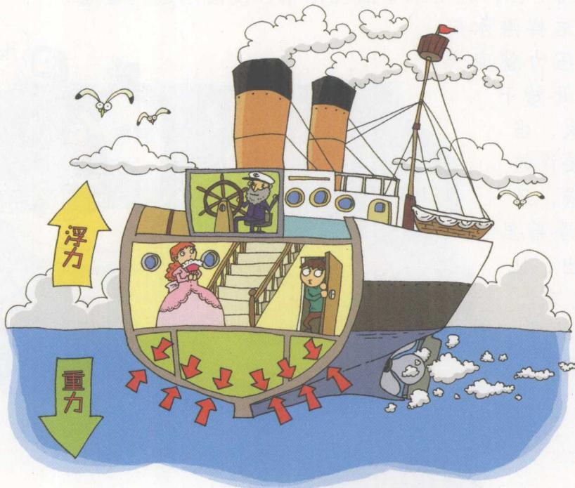
把一个小铁钉放在水里，它会很快沉下去，但是为什么用铁造的大船就能安安稳稳地浮在水面上呢？秘密在于“船的构造和外形”。船的内部是空的，外面被薄薄的铁皮包住，所以即便是足球场那么大的船，因为内部是空心的，使它看起来并没有那么重。
