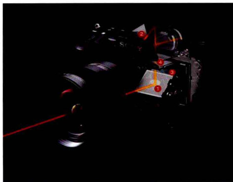
数码单反相机成像原理图
