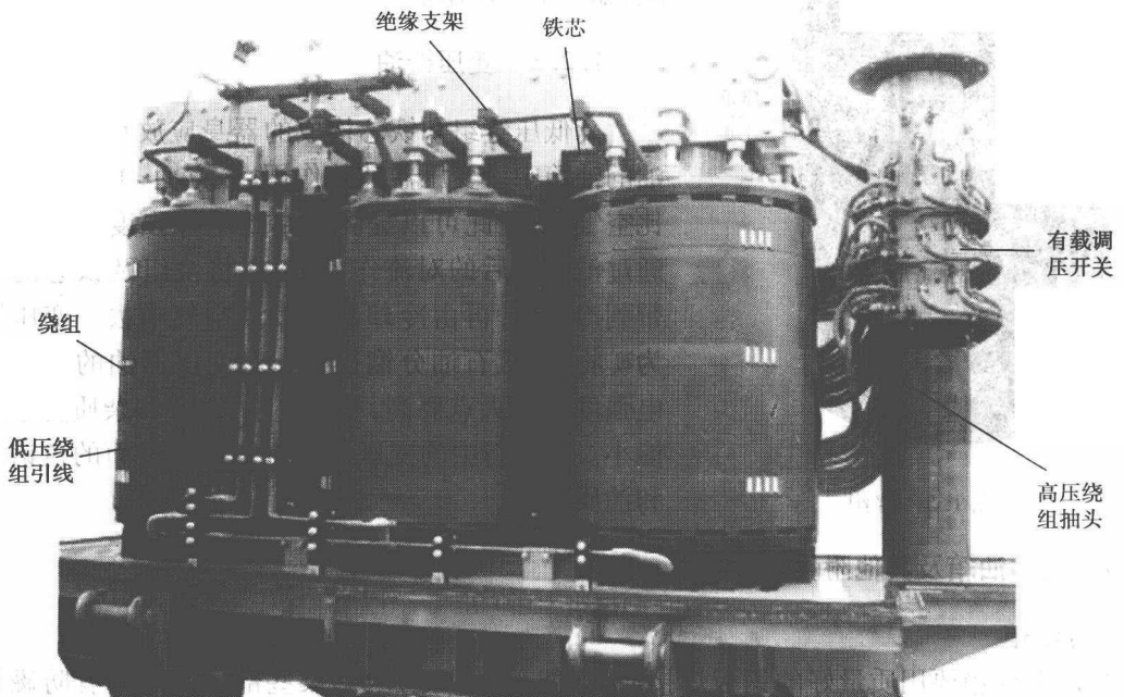
图 1.3 三相油浸式电力变压器的器身
