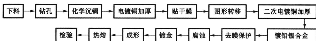
图 2-2 双面印制板加工流程
