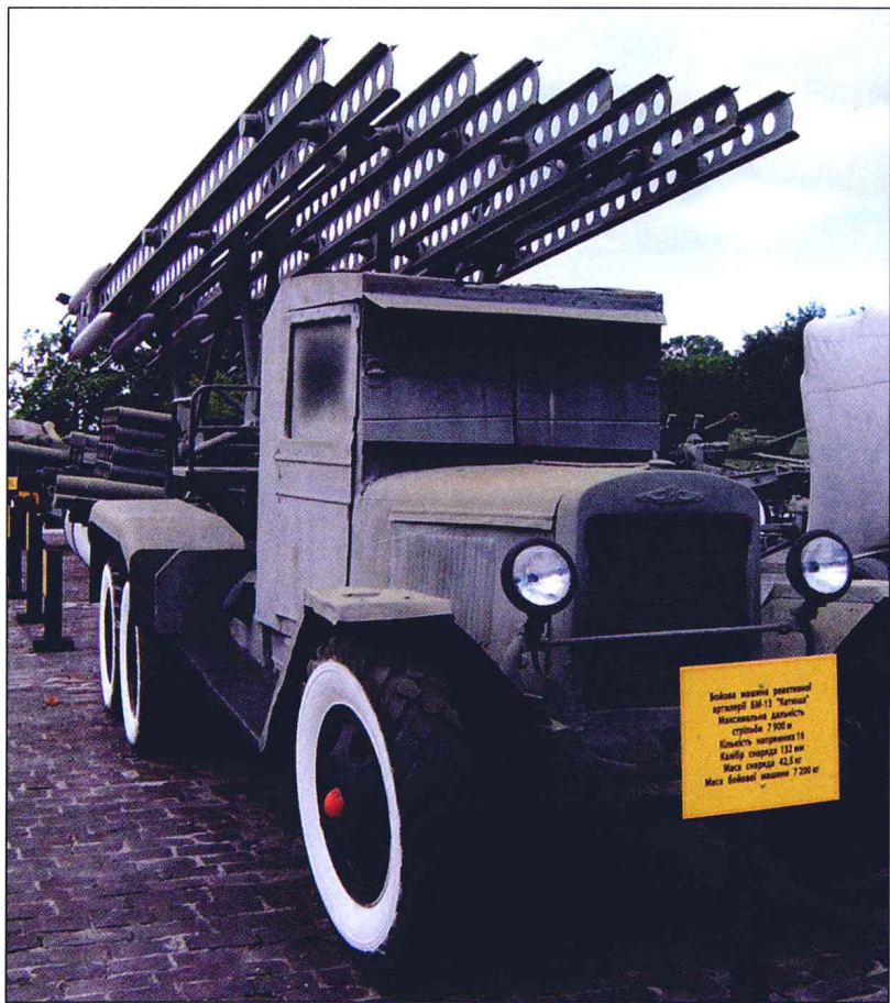
▲ 苏联的 BM-13 “喀秋莎” 有一排导轨，它们固定在 ZiS-6 卡车上。发射时，16 枚 M-13 火箭弹沿着这些导轨滑动冲出。
