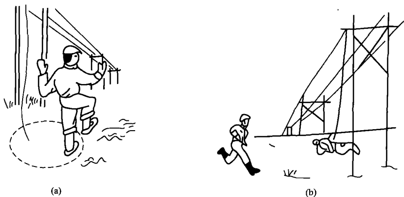
图 1-9 脱离跨步电压及救人示意图
