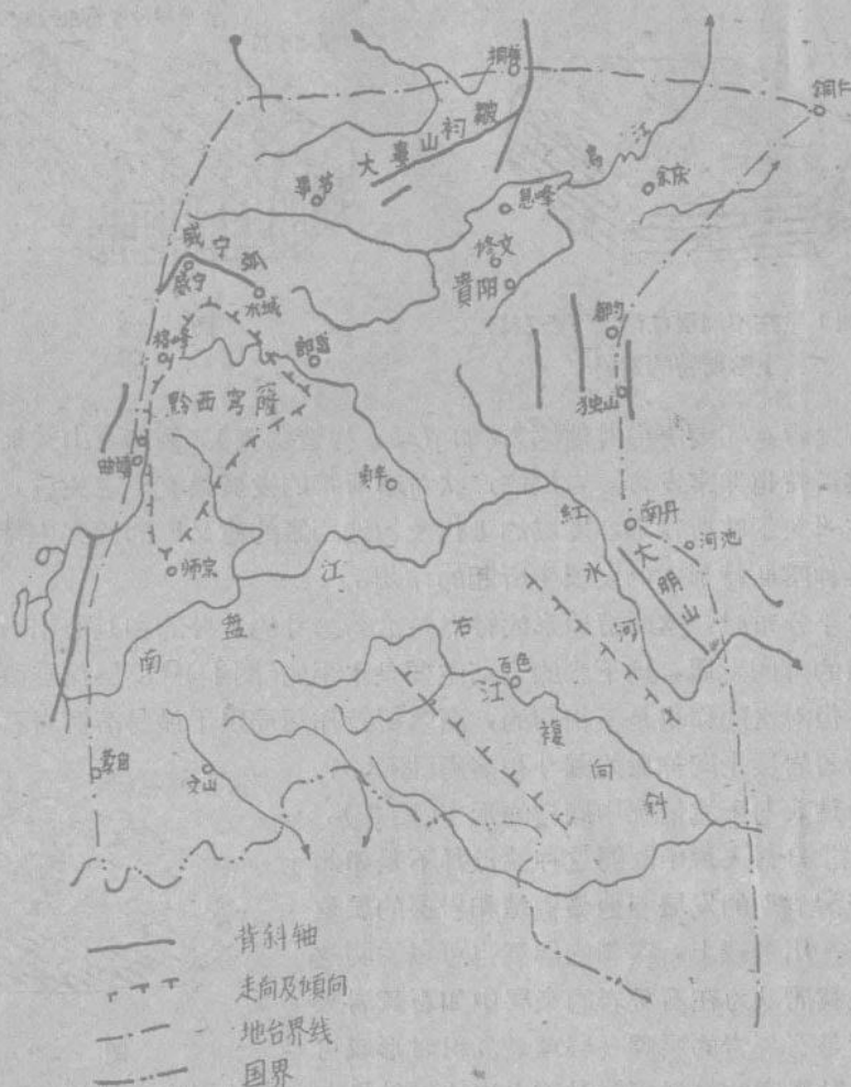
图4 黔桂地台构造线图 〔根据常隆庆, 杨鸿达 中国地质学〕
