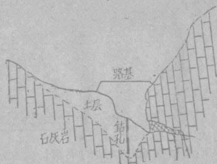
图15 路堤下溶洞示意图
