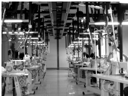
图 1-6 服装智能吊挂生产系统
