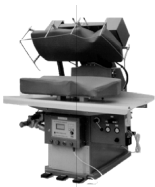
图 1-7 烫模的熨烫机
