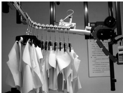
图 1-6 服装智能吊挂生产系统
