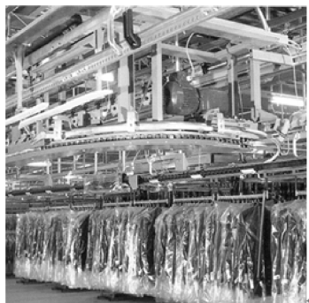
图 1-9 立体真空包装、吊挂储运设备
