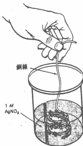
圖 11-3 在一燒杯中，Cu 被氧化， \text{Ag}^+ 被還原。
