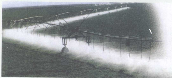
彩图 3-5 行走 平移式喷灌机
