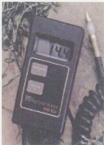
彩图 6-10 DHT-1 型 手持饲草水分检测仪
