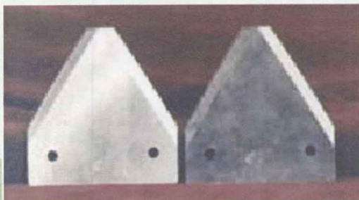
彩图 4-1 内蒙古 海拉牧机械总厂 标准 I 型动刀片
