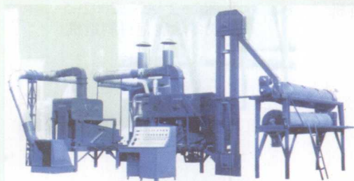
彩图 5-4 9CJT-300 型 牧草种子加工成套设备
