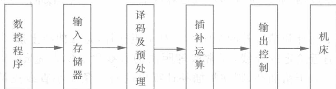
图 1-6 数控系统工作流程图
