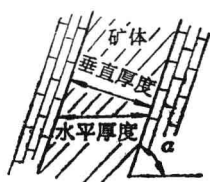
图 1-1 矿体的垂直厚度和水平厚度
