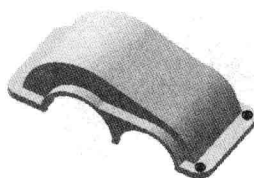
图 1.14 M8 六角头螺栓的柱形沉头孔 1
