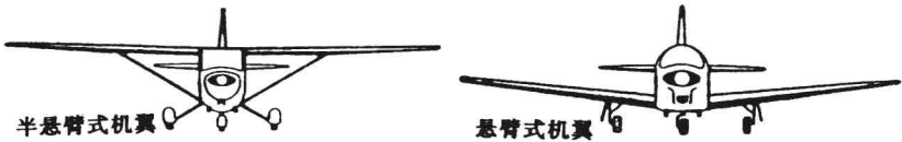
图 1-3 半悬臂式和悬臂式机翼
