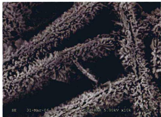
一六 东莞鸦片战争博物馆铁炮锈蚀物的扫描电镜图
