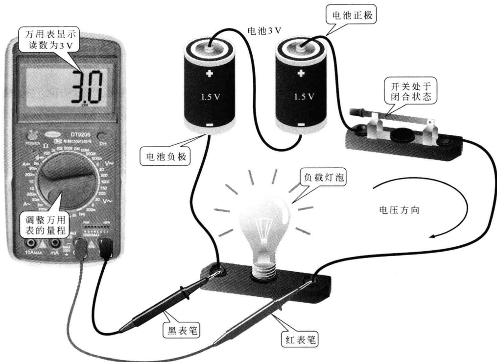
图1-3 数字式万用表测量直流电压值的示意图
