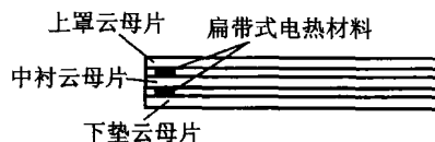
图 1-2 罩盖式电热器件的结构
