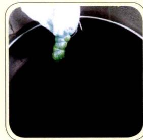
**图15:** 然后将面料从染液中捞出,用清水将果绿色的浮色清洗干净。
