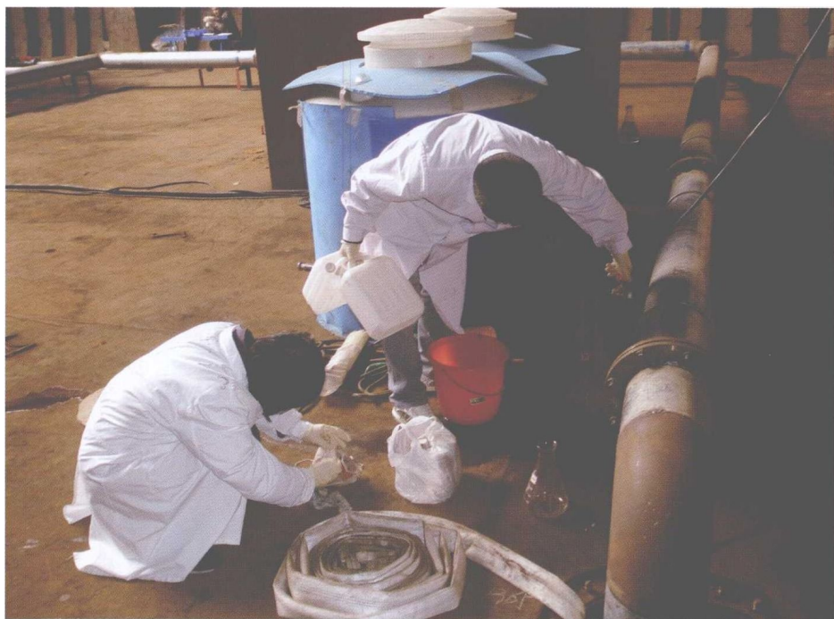
彩图14 在处理系统管路中取样
