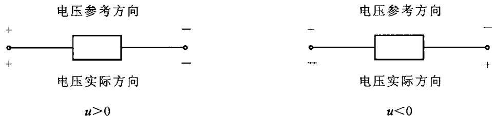
图 1-8 电压的实际方向和参考方向的关系
