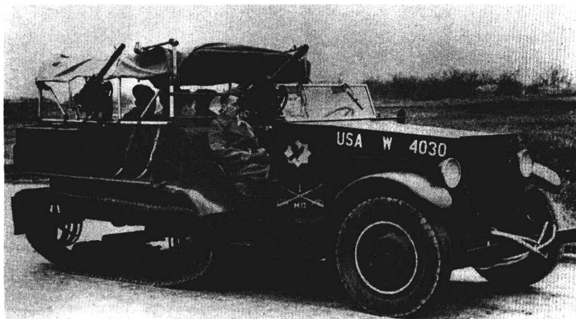
■ 在美军中正式服役的T1E1型半履带汽车，被军方正式命名为M1型，总共有30辆M1型半履带车装备美军。该车安装3挺7.62毫米M1919型勃朗宁轻机枪，分别位于副驾驶和后车厢两侧。有部分半履带汽车安装有野战电台。
