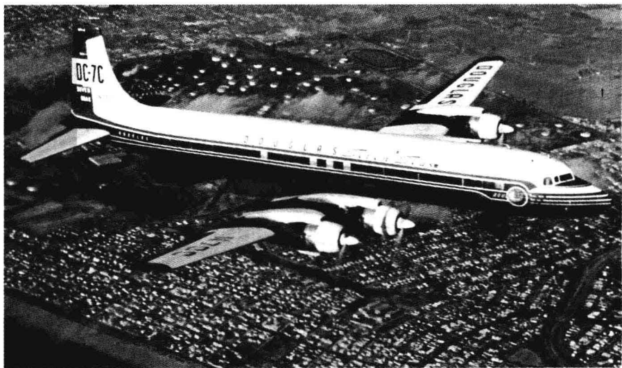
图 1-1 末代活塞发动机,如洛克希德公司的星座系列和 DC-7C(如图)发动机故障率为每千小时 0.89 次。现有的喷气发动机发动机故障率为每千小时 0.002 次(泛美)
