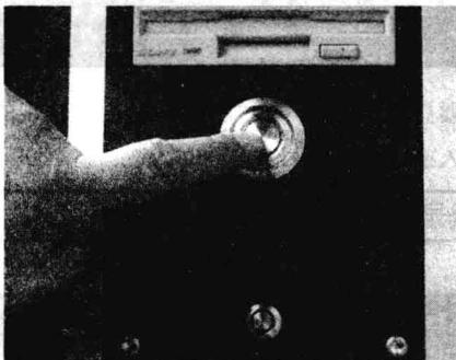
第1步：检查电脑的电源线，确保它已与电源插座连接好。然后打开外部电源插线板的开关。
