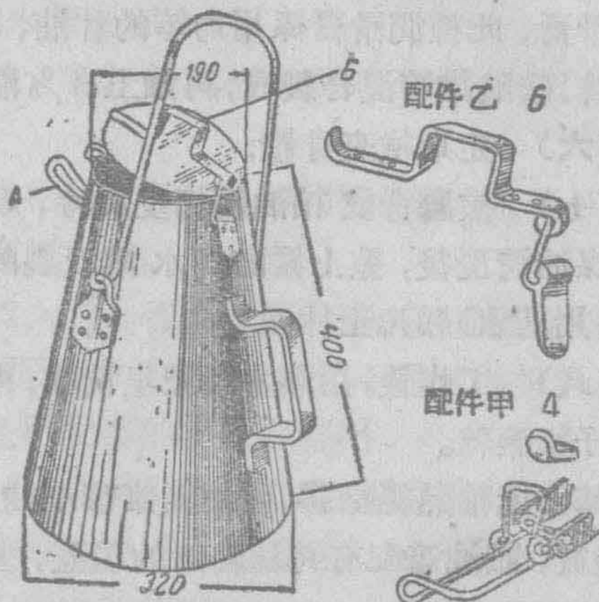
圖1 盛放熱絕緣膠用的圓錐形小油箱
