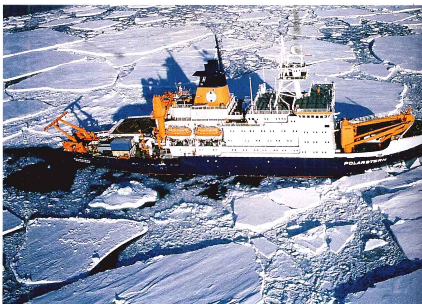
德国破冰船“极星号”。这艘破冰船动力强劲，船体外覆盖有钢甲，可以穿越5米厚的浮冰区。
