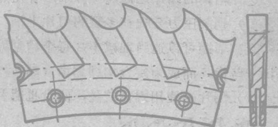
圖 6 凹形鉗脚刀片。
