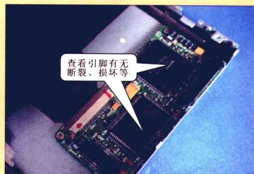
光驱中的电路板
