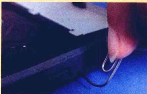
使用手动开关打开光驱
