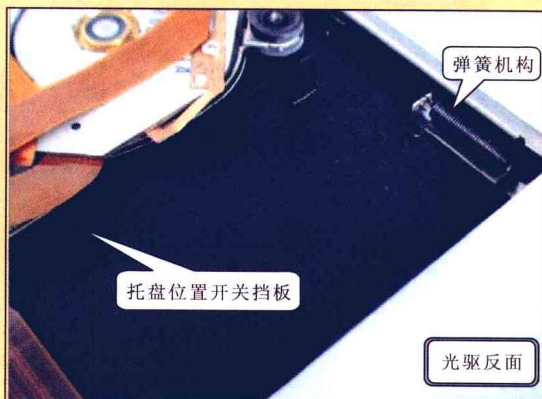
托盘加载机构
