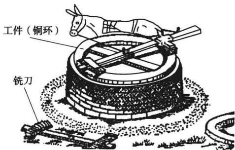
图 0-2 1668年天文仪器上铜环的铣削和磨削
