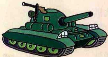
喷火坦克和其他坦克有什么不同呢？喷火坦克是一种装有重型武器的特种坦克，它是一种能喷火的坦克。喷火坦克喷射出的火柱温度可以达到800℃到1000℃，射程可以达到250米以上。喷火坦克的攻击力很强，它的火焰喷射器能在近距离内杀伤敌方战斗人员，烧毁敌方堡垒和各种武器装备，为进攻开辟道路。喷火坦克的防守能力也不弱，它能设置火障，阻挡敌方的攻击。
